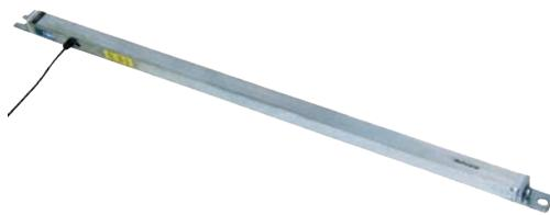
MEMS 梁式测斜仪可以垂直或水平安装在建筑物表面，用来测量建筑物可能发生的倾斜或沉降。将其首尾串接在一起，可以测量油气管线、建筑物主体等整个监测剖面的不均匀沉降，还可以垂直安装用来测量基坑连续墙、支撑板桩等的水平位移。其中 BSIL-TLT1D 采用 BSIL-Micro-MCU 或 DataTaker 自动化数据采集仪进行数据采集。
