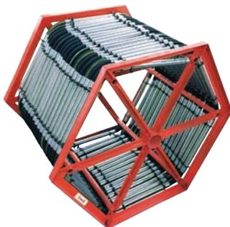
BSIL-SI 多维度变形测量系统主要适用于土体水平位移及剖面分层沉降监测，特别适合边坡等内部变形较大的深层位移监测，以及堆石坝混凝土面板挠度、路基沉降等挠度监测。该装置具有较大幅度的任意角度柔性适应能力（轴向  $\pm 90^\circ$  范围内任意弯折），以充分适应土体在发生较大剪切变形时仍能持续可靠地工作，并真实反映整个型面的位移变化状态。装置采用细直径设计，现场安装简单方便，即埋即测，获得初始数据及时。
