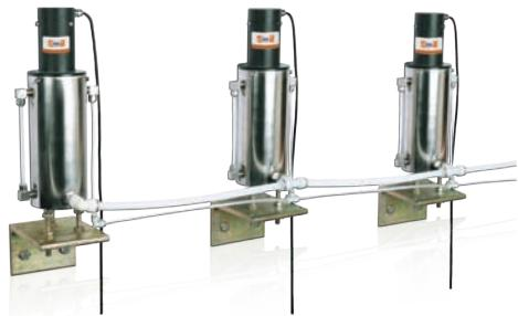
BSIL-W10-DM 系统由一系列包含液位传感器的储液容器组成，各储液容器由通液管及通气管相互连通，通过测量测点相对于基准点的液位变化来反映被监测点的沉降或抬升情况。
