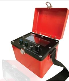
BSIL-RO-MEMS 型读数仪专门用于对微电子机械式 (MEMS) 传感器 (如 BSIL-C12A/C12B 型固定式测斜仪 / 倾角计等) 的读数，采用显示清晰的大尺寸液晶屏方便任何条件下的读数。读数仪接口可提供 MEMS 型传感器所需的激励电源，内置的锂离子电池组可反复充电使用，仪器操作简单，携带方便。
