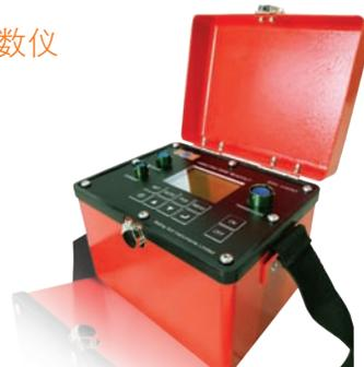
BSIL-RO-VW 型振弦式读数仪适用于振弦式传感器的数据采集。仪器选用轻巧的优质铝合金外壳，采用全密封结构设计，可在各种恶劣环境下工作。体积小、重量轻，携带十分方便。大屏幕液晶显示器具有高亮背光，即使在夜晚也能清晰显示读数。使用可重复充电的大容量锂离子电池供电。读数仪不仅可直接显示各种振弦式仪器的信号与温度，存储的数据还可通过通讯电缆连接到计算机上并输出到电子表格或数据库中。
