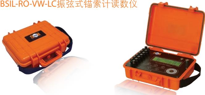
BSIL-RO-VW-LC 振弦式锚索计读数仪用于振弦式锚索计的数据采集，最多可同时接入 6 支振弦传感器及 1 支温度传感器，特别适合锚索计在现场张拉、率定或日常观测中的数据获取。
