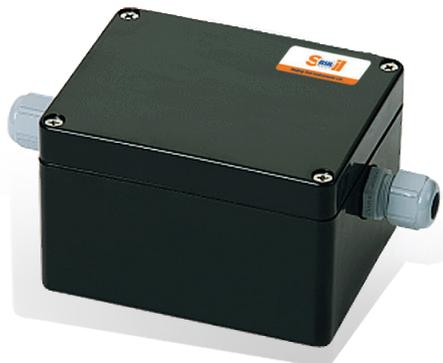
BSIL-CM型也称作振弦信号转换器，用来桥接部分数据采集系统不能直接采集振弦式传感器的信号问题，适合具有标准电流信号测量接口的数据采集设备。
