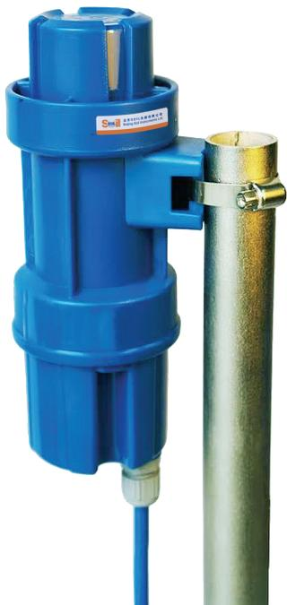
BSIL-GL2-XX云终端可接入振弦式、差阻式、电位计、标准电压及数字量等多类型的仪器，云终端的接入通道数量分为单通道与6通道两种。单通道型无线终端采用全密封结构并且内置天线，仅有一个或6个电缆接口用以连接监测仪器，在现场时只需与传感器连接即可投入工作。电缆接口提供直连型与可插拔接口两种，前者适合永久连接，后者便于与读数仪连接进行人工比测。
