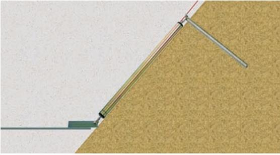
BSIL-J2I 型振弦式界面变位计 (位错计) 用于测量填土或结构的边界位移, 如土体-基岩之间、土体-混凝土之间或土体与其它介质之间的顺缝错动位移。适用于测量堤坝、芯墙、护坡、填土等与基础结构面之间的位错、相对沉降。仪器采用埋入式安装, 可直接埋设在监测点。此外, 增加柔性保护措施, 仪器还可埋设在混凝土-基岩之间测量顺缝错动位移。
