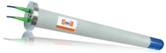
BSIL-GS310/GS310T 型光纤光栅埋入式测缝计适用于测量混凝土、岩石、土体和结构物伸缩缝的开合度。内部万向节允许一定程度的剪切位移。防水性能好、耐腐蚀性强。
