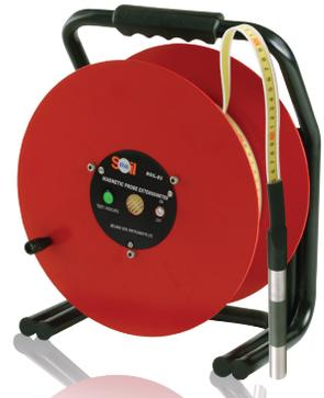
BSIL-E2 型电磁沉降仪适用于土石坝、边坡、填土的分层沉降监测。仪器由含有导线的钢带尺、不锈钢磁性探头、声光指示器电路及平尺卷轴等组成。当探头接近安装有磁性沉降环的区域时，将感应到磁信号并通过导线传递至卷轴内的声光指示器指示。
