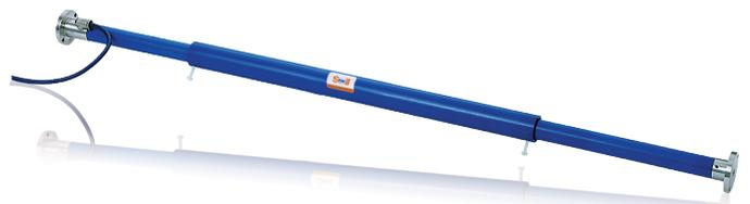
BSIL-E7 型土体位移计两端带有法兰盘，适合埋设在土体中测量填土、公路路基、堤坝的土体位移变形。将多支 BSIL-E7 型土体位移计串连使用可获取多个测点的水平位移；或通过灌浆或液压锚头锚固在钻孔内，以测量钻孔的轴向变形；将其与 BSIL-C12B 型固定式水平测斜仪配合使用，可获取剖面的水平与垂直位移曲线。单支仪器长度可在 1~30m 范围内选取。
