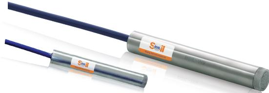
BSIL-W9 系列渗压计适合埋设在水工建筑物和基岩内，或安装在测压管、钻孔、堤坝、管道或压力容器中，以测量孔隙水压力或液位。主要部件均采用特殊钢材制造，适合在各种恶劣环境中使用。标准的透水石选用带 50 微米小孔的烧结不锈钢制成，具有良好的透水性。特殊的稳定补偿技术使传感器具有极小的温度补偿系数。在完善电缆保护措施后，可直接埋设在对仪器要求较高的碾压混凝土中。
